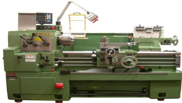
**Torno Copiador:** Los tornos copiadores o seguidores, siguen una plantilla para reproducir una forma exacta en una pieza de trabajo. A menudo se emplean aditamentos seguidores o copiadores en los tornos motorizados o revolver
